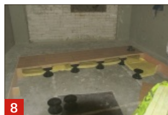
8 Testopstelling houten proefvloer in het akoestisch laboratorium
